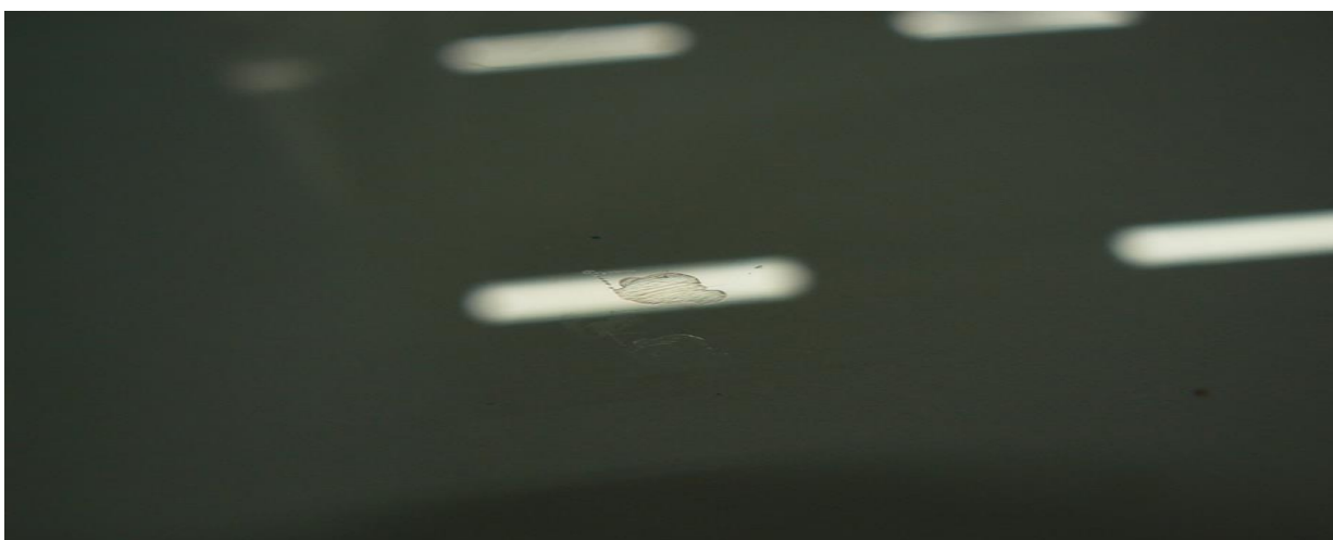
GOED: Sterreparatie voldoende gevuld en oppervlakte afgewerkt
